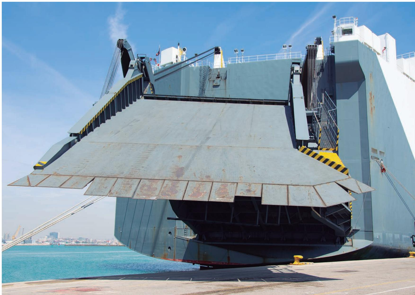
La rampa de carga del buque "Höegh Tracer" tiene capacidad para 375 toneladas, permitiendo un acceso a cubierta principal de 12 metros de anchura por 6,5 metros de altura. Foto Alba Prado.
