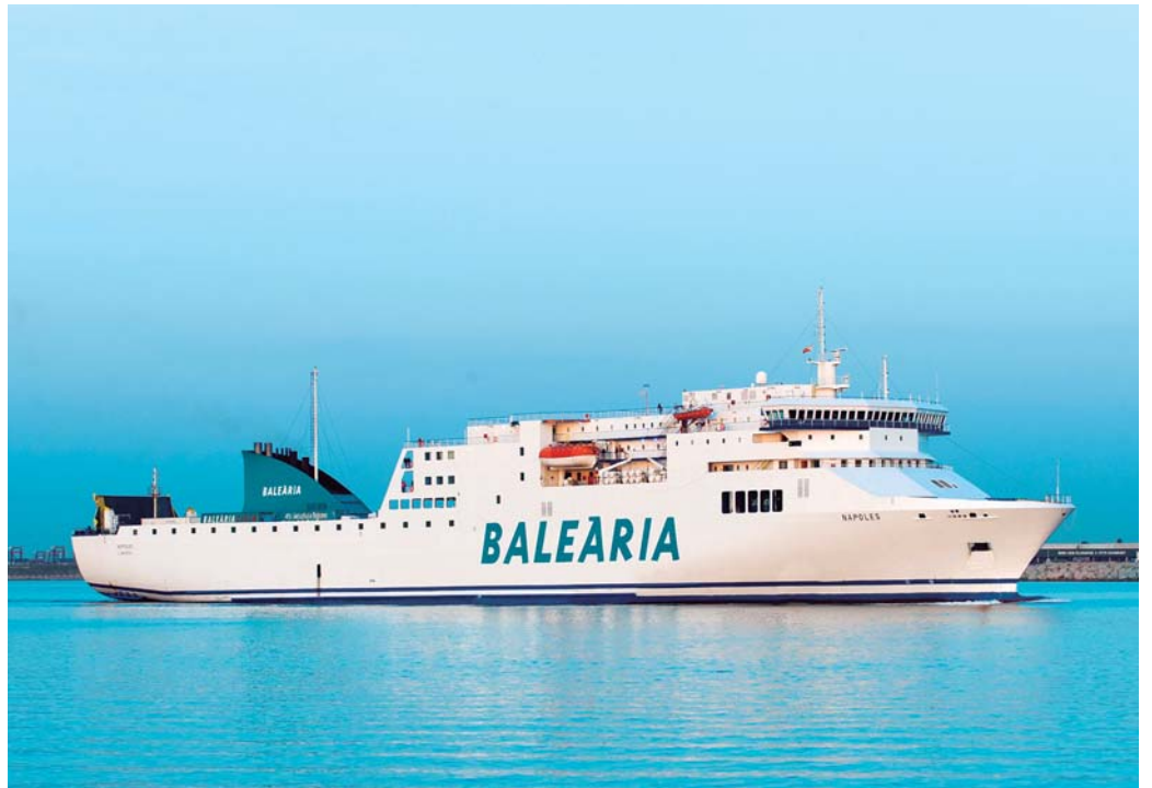
El "Nápoles" es uno de los cinco buques ro-pax de Baleària que serán remotorizados para poder utilizar GNL.
